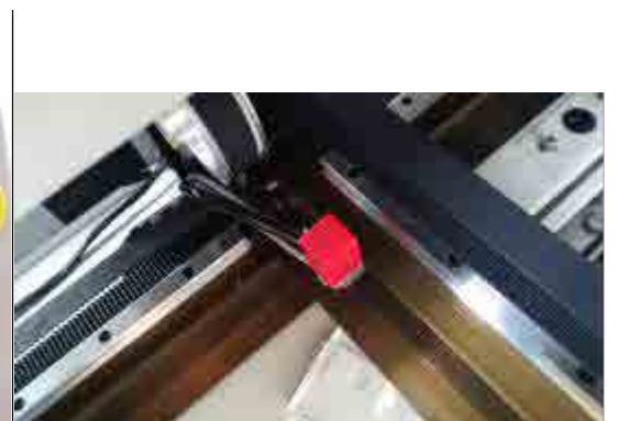
PMI Guías lineales y switch inductivo
